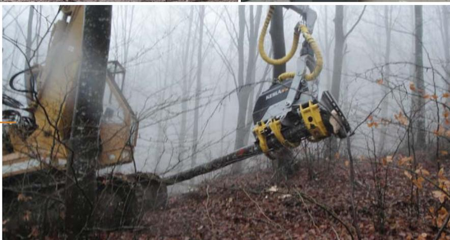
*foto: Processore montato su escavatore in fase di sramatura in faggeta (Covigliaio)*
