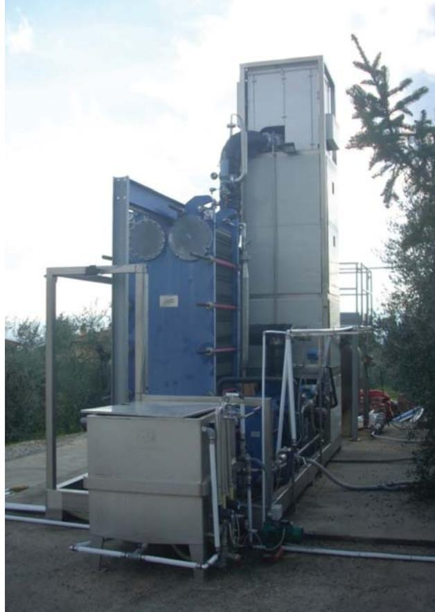
Foto 1: L'impianto di evaporazione/condensazione installato presso il Frantoio Santa Tea (Reggello)
