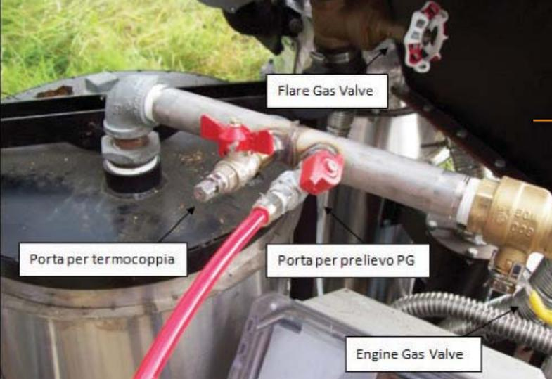
foto: Punto di prelievo usato per il campionamento del gas.
